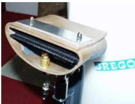
Saug- und Waschdüse beim Vakuumwaschverfahren
